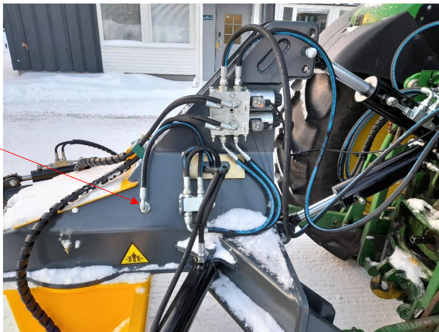
Kuva 19. Paineakku sijaitsee kääntörungon sisällä.
